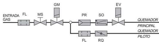
Versión con dispositivo manual de regulación del caudal de gas
