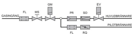
Utförande med anordning för manuell reglering av gasflödet
