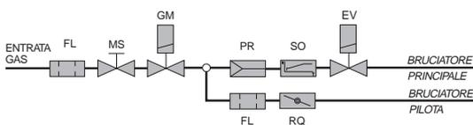
Versioni con dispositivo manuale di regolazione della portata di gas
